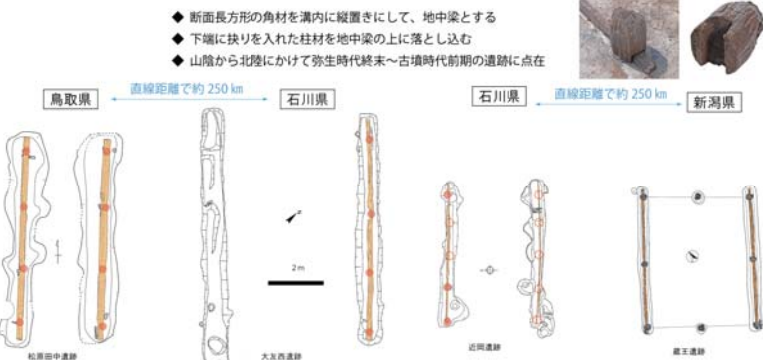
図12 地中梁を伴う布掘建物の比較
