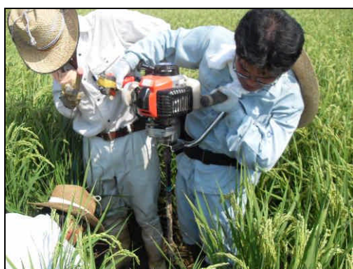
<写真 5. 観測管設置—農業試験場>
