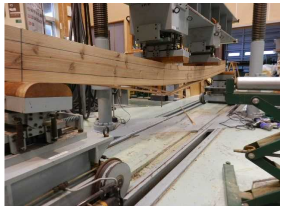
図 1 曲げ強度試験の状況
