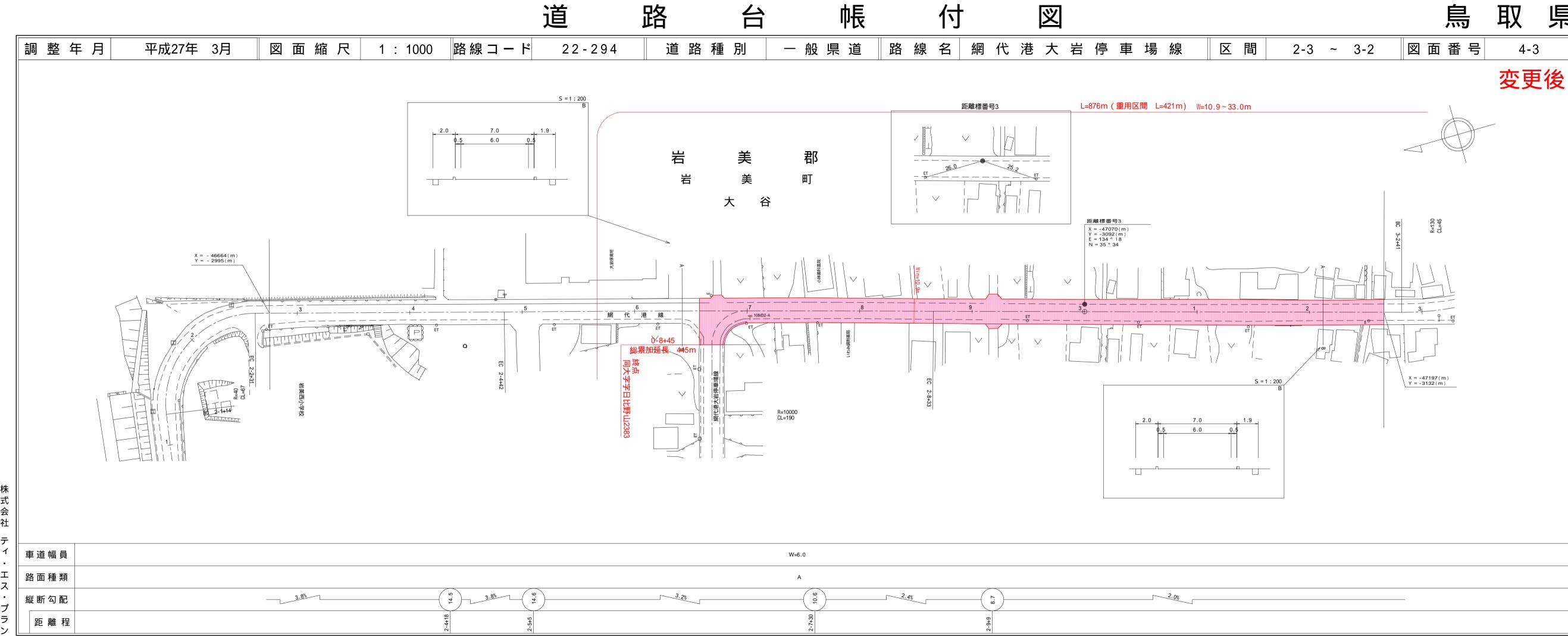
道 調整年月 図 面 縮 尺 1:1000 路線コード 区間 平成27年 3月 道路種別 図面番号 22-294 3-3 ~ 4-3 S = 1 : 200 距離標番号4 岩美郡岩美町大字大谷字日比野前1565-2 L=876m (重用区間 L=421m) W=10.9~33.0m 大 距離標番号4 X = -47561 (m) Y = -3139 (m) E = 134 ° 18 N = 35 ° 34 X = -47197(m) Y = -3132(m) X = -47773 (m) Y = -3114 (m) カルバートボックス W=1.6 H=1.2 カルバートボックス W=5.0 H=1.2 車道幅員 W=6.0 路面種類 縦断勾配
