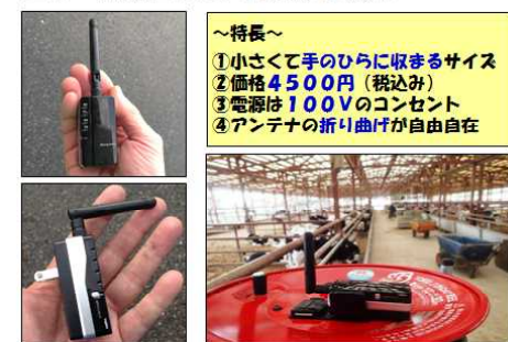
図7 無線LAN中継機を導入
