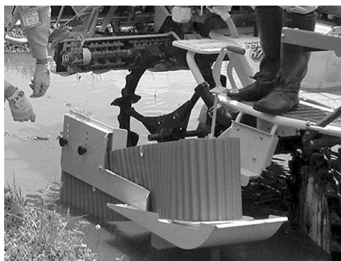
写真1 畦畔シート埋設機 (FS)
