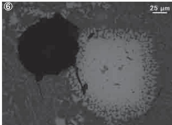
写真34 流出溝滓・炉壁の顕微鏡組織
