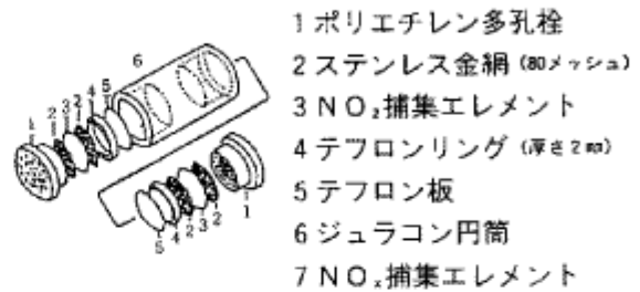
図4 \text{NO}_x サンプラー(横浜環科研方式)構造図
