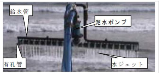
砂集積実験装置(有孔管式簡易浚渫装置)
