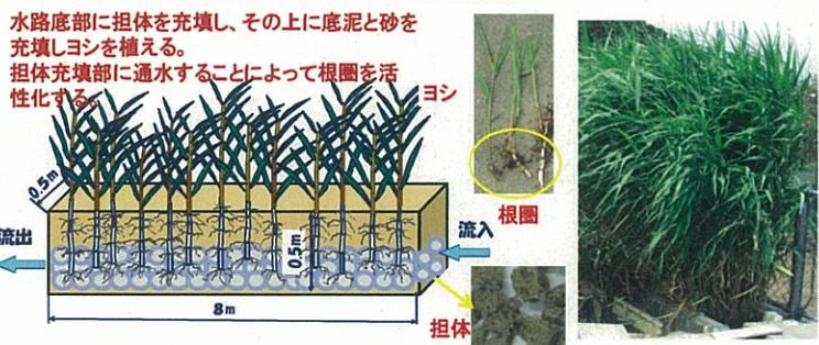
**浄化装置の特徴**：微生物と水生植物を組み合わせた水質汚濁性物質の除去
