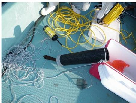
図1 バイ稚貝の放流器(農業資材のトリカルパイプで作成)
