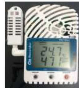
CO 2 濃度・温度・湿度 データロガー (TR-76Ui) で計測
