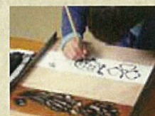
型紙と墨を使った種糸づくり。種糸台に糸を張り、下絵に合わせて、糸に墨をつけ、墨付け部分を括る。
