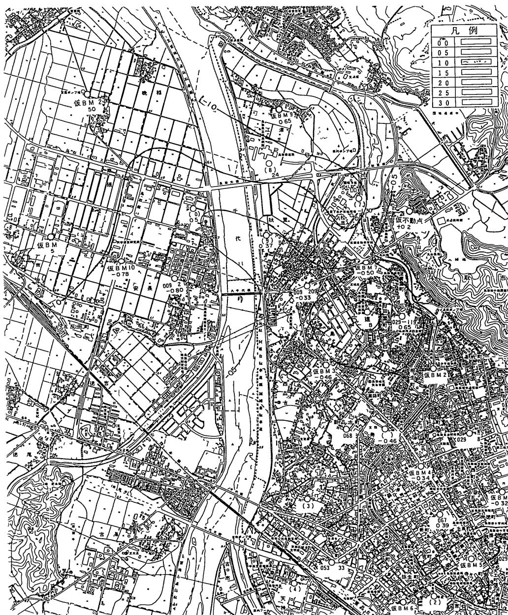
凡例 昭和 61 年 7 月～昭和 62 年 7 月の沈下等量線
