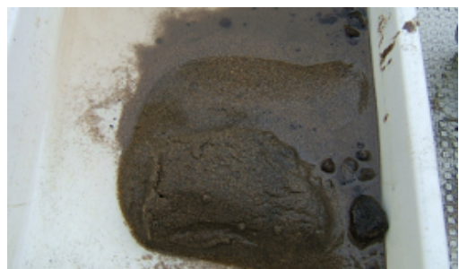
図6 試験施工区における採泥サンプル 底質表面上にシルトの堆積は観察されず (2010年3月1日)。
