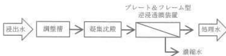
図 8.6-35 プレート&フレーム型 逆浸透膜装置の処理フロー
