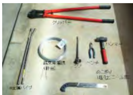
柵の設置に使用する工具等の事例
