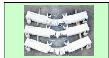
破壊形態は同じ。写真上：通常はり，中：溶融スラグはり，下：廃瓦 T はり
