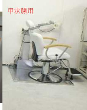
ですが様々な校正・補正を行い、正確な検査を行います。ホルボボディカウンタは原子力災害が発生した際に、放射線被ばくを受けた方を検査するための装置です。内部被ばくの状況を正確に求め、その後の治療に役立てることを目的としています。
