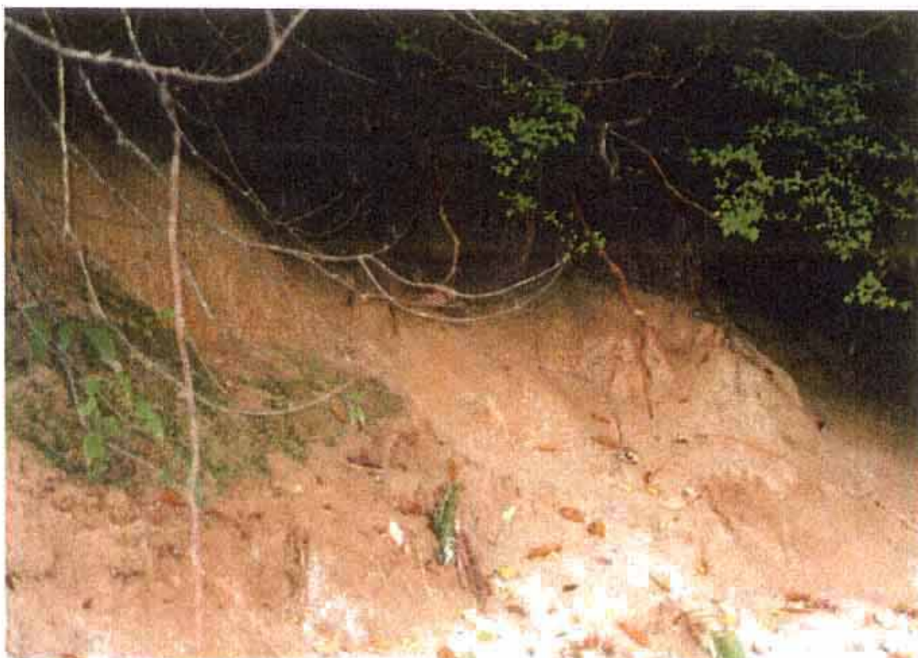
P-27 P-24 の露頭の近接写真。DH～CL 級の花崗岩が露出。
