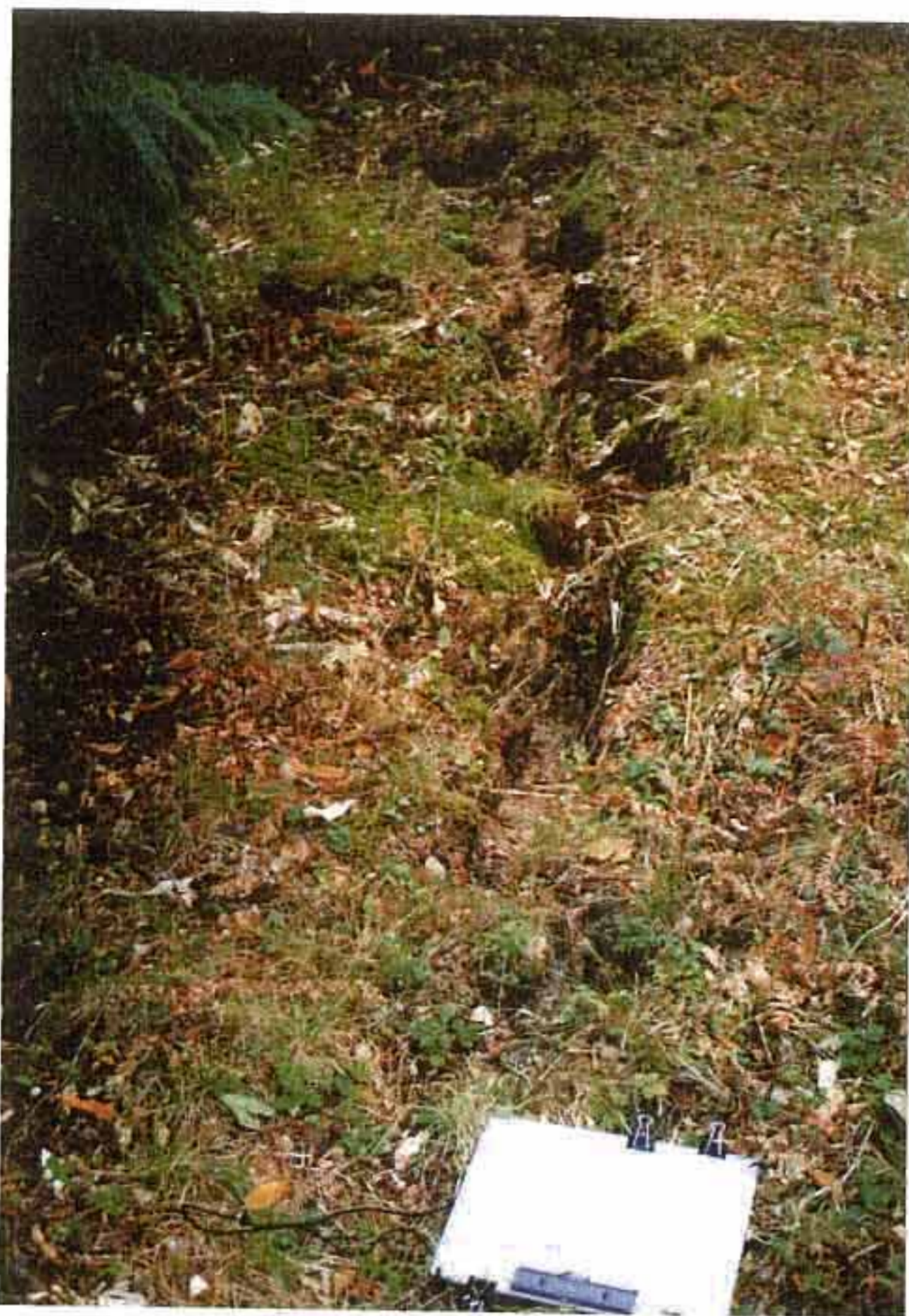
P-34 同じく 388m 盤（切盛境）に生じた 長さ 6~7m、最大開口幅 40cm、段 差 30cm 程度のクラック。
