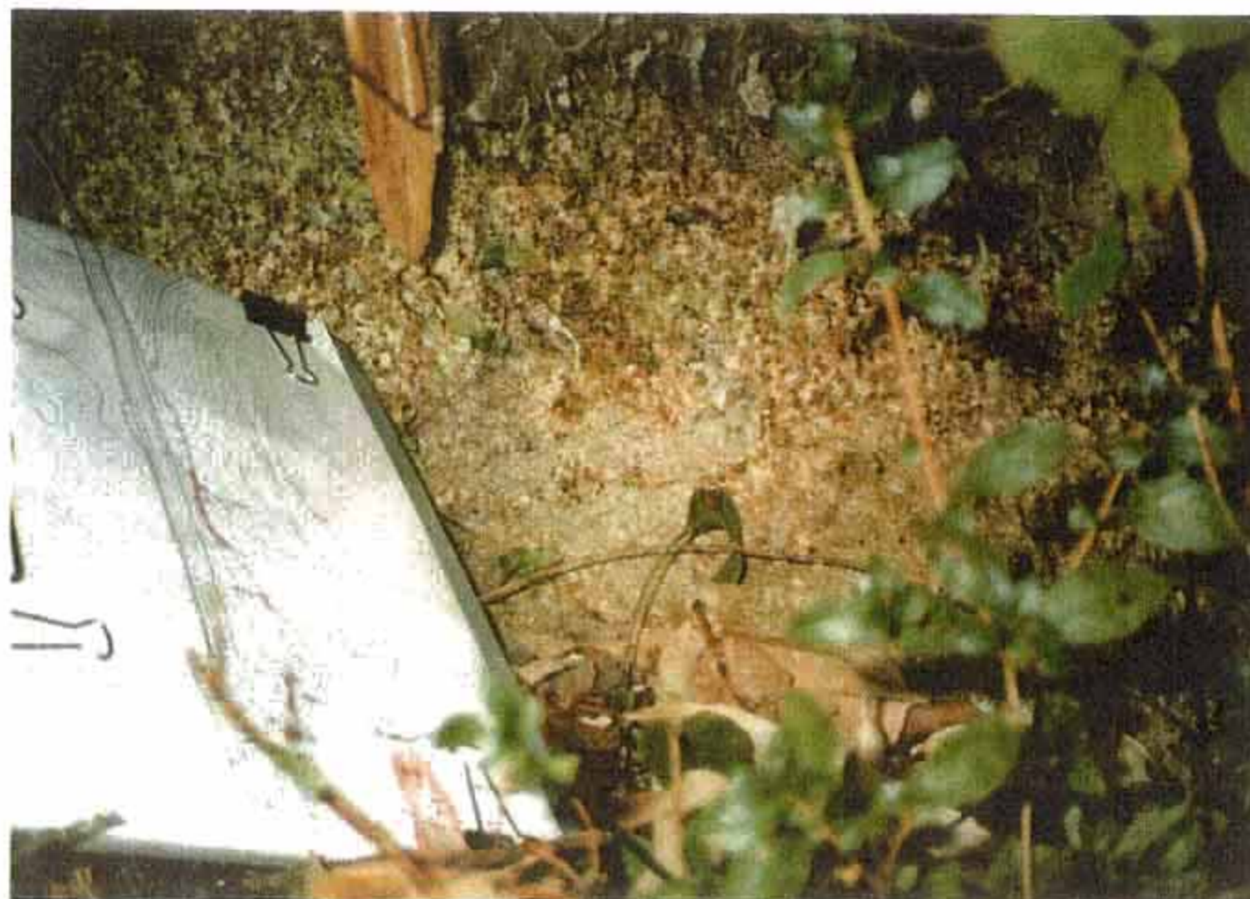
P-9 No.2 固定台付近の小規模な切取部に露出する風化花崗岩 (DM~DH級) 極めて粗粒である。
