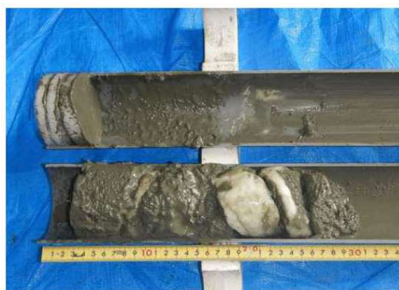
写真1：ピストンコアラーで採取されたメタンハイドレート。海底の細粒堆積物中に氷状のメタンハイドレート(白色)の塊が挟在する。ピストンコアラーが厚さ約8cmのメタンハイドレート層を貫入したと考えられる。
