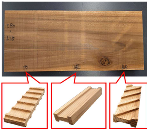
図3 各加工栈木で生じた栈木痕
