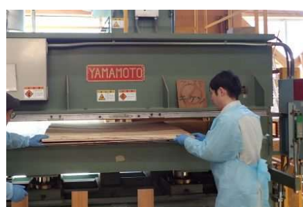
写真2 プレスによる接着の状況
