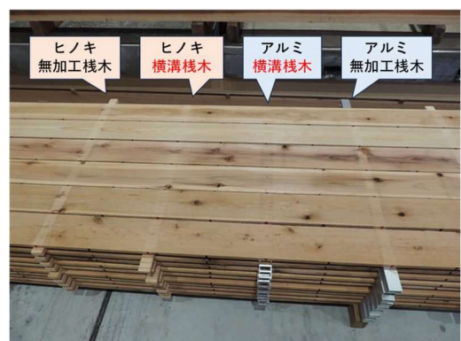
写真3 栈木痕の発生状況
