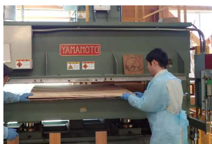
写真2 プレスによる接着の状況
