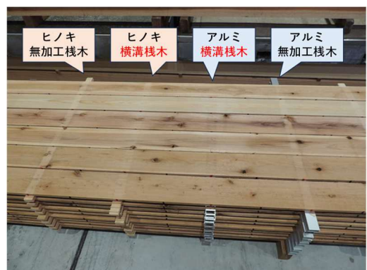
写真3 栈木痕の発生状況
