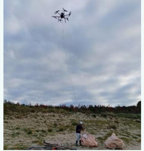
大型ゴミのドローン運搬
