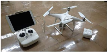
図5 ドローン、送信機、送信機端末 左から送信機とタブレット端末、ドローン本体（Phantom 4 Pro(DJI製)）、バッテリー（予備）
