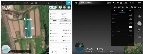
図6 飛行制御アプリと機体制御アプリにより設定する様子 左：飛行制御アプリ(DJI GS Pro)で設定する様子 右：機体制御アプリ(DJI GO4)よりカメラ設定を行う様子。
