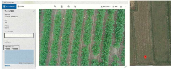
図4 空撮画像ファイルからGoogle map上に表示する様子 左：PC上で空撮画像を選び右クリック、プロパティから位置情報を確認（Windows10の場合） 右：位置情報をGoogle map上に入力することでアサガオ発生位置を表示可能
