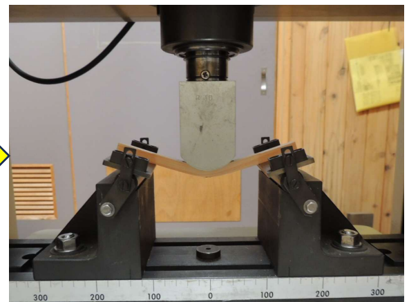
写真6 強度試験機による曲げ試験
