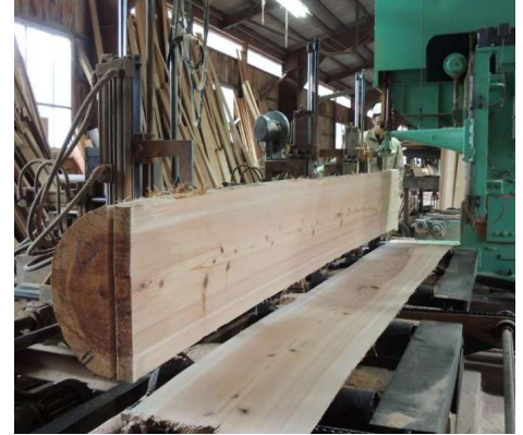
写真2 総柵目板の製材
