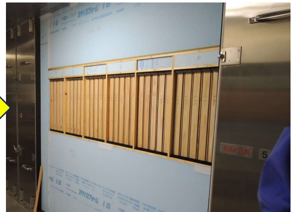
写真7 環境試験機を使った反り試験
