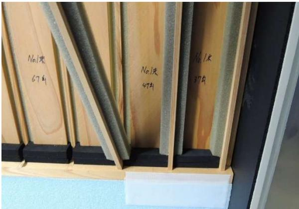
写真3 試験体の固定(B室側)
