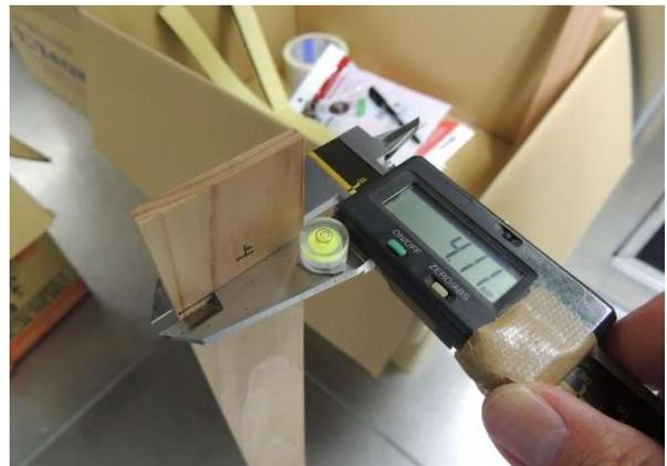
写真4 反り変形の測定
