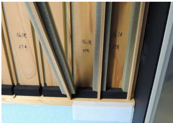
写真3 試験体の固定(B室側)
