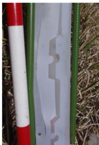
写真3 積雪によって生じたツリーシェルターAの亀裂
