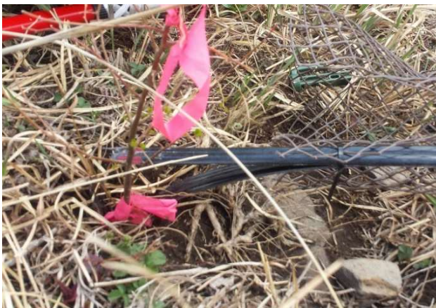
写真5 積雪によるツリーシェルターCの支柱の割れや破断
