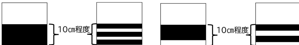
②段鼻の幅が狭い場合…上から見下ろした際、段鼻部分の面積が小さいため、段に気づかない場合があります。
