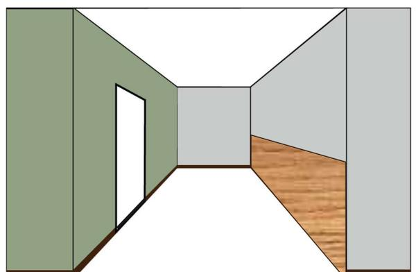
良い事例5は、床面は明度の低い灰色とし、壁面は明度の高い白色を配色しています。床面と壁面において色のコントラスト(色の明度差)が確保できなかった場合、壁面の巾木(相互に近接する部分)において、明度の低い茶色を配色し、色のコントラストを確保した事例です。
