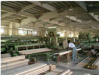
製材所(若桜町) 住宅に使われる板や柱、土台などを作っています
