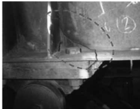
亀裂が生じている。
