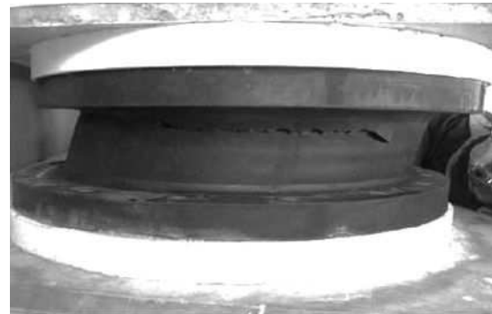
パターン 4 ゴム支承の破損・異常な変形が生じている。
