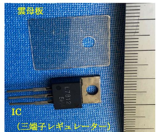
写真4 電源用ICと雲母絶縁板
