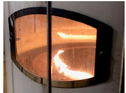
写真3 雲母が使われている灯油ストーブの窓
