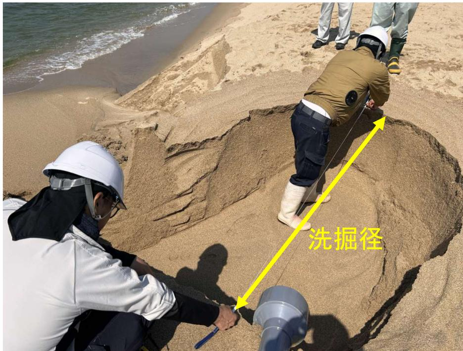
各実験条件での洗掘径の時間変化を見ると、落水開始60秒までに一気に洗掘が進み、その後は洗掘される水平範囲はあまり大きく変化しないことが確認された。
