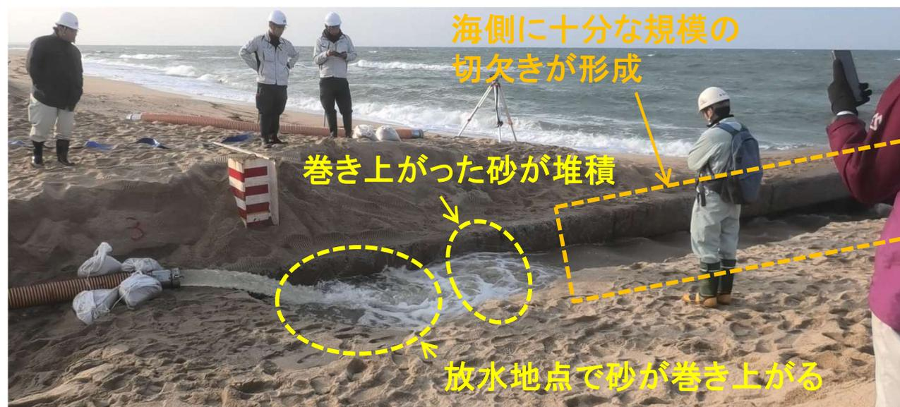
$0.08\text{m}^3/\text{s}$ の放水を砂州の海側法肩寄りの天端上から5分間実施することで、十分な規模の切欠きが形成できた。しかし、砂州の上流側に放水した場合、効果的に切欠きを形成することができなかった。
