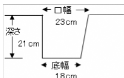
図1 明渠掘機による当初の施工形状
