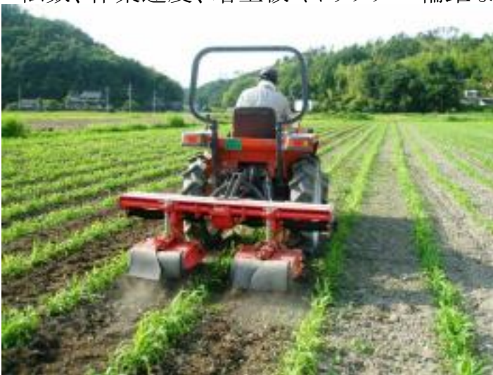
写真 11 ロータリカルチによる中耕作業
