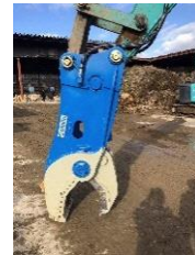
▶油圧式産廃カッターを導入することで、廃棄物の分別や粉碎の作業が簡略化され、作業時間が大幅に減少した。
