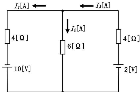
$I_1 : 1.75 \text{ [A]}、I_2 : -0.5 \text{ [A]}、I_3 : 1.25 \text{ [A]}$
