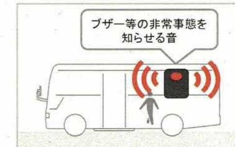
エンジン停止から一定時間後にセンサーによる**車内の検知**を開始
