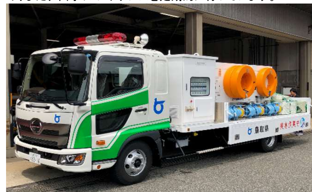
▲近年増えている集中豪雨に対応するため、配備している排水ポンプ車
