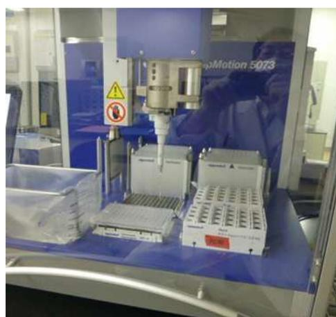
図2. 試薬自動分注装置
