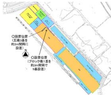
図5 簡易構造物の設置位置
