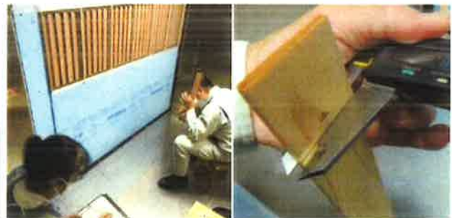
写真2 試験体の設置(左)と幅方向における反りの計測(右)
