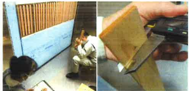
写真2 試験体の設置(左)と幅方向における反りの計測(右)
