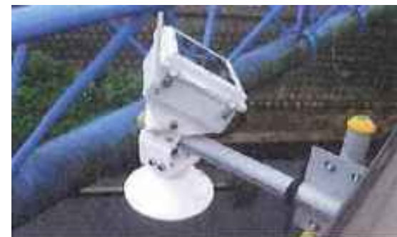
低コスト型水位計の設置例
