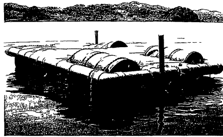
水質浄化試験に用いるパイプイカダ
