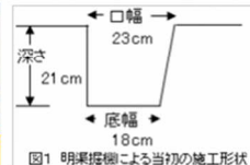
図1 明渠掘機による当初の施工形状
