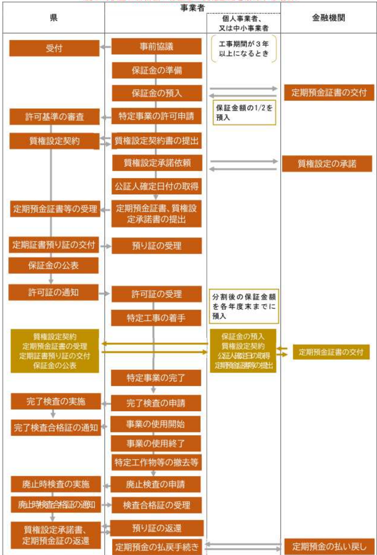
「盛土等に係る斜面の安全確保に関する条例」における保証金の手続きに関するフロー図 (廃止時検査の合格後に保証金の質権設定を解除する場合)
